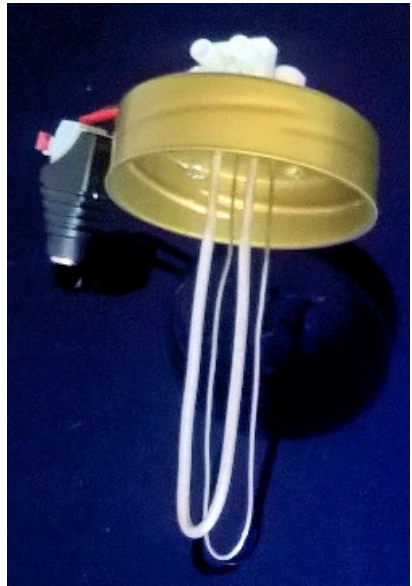
Abbildung: U-förmige Silber-Anode (2,5 mm) und U-förmige V2A- oder V4A-Kathode.
